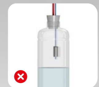
A tömlők helyes elhelyezése a táp- és szennyvíztartályokban.
